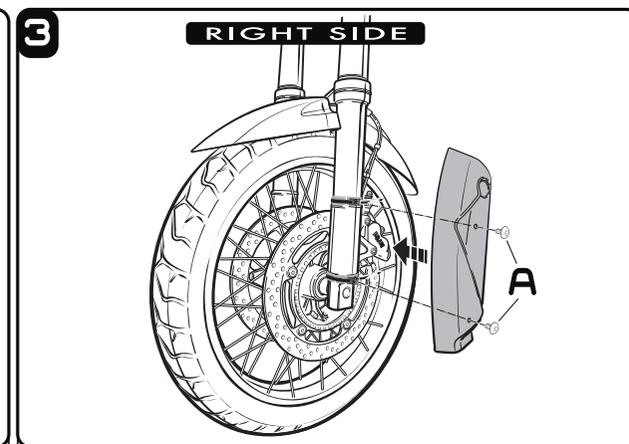
Montare i carter su entrambi i lati ruota e fissare con le viti **A** in dotazione.
