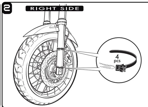
Montare i supporti filettati con le fascette in dotazione su entrambi i lati ruota evitando di serrarle completamente.
